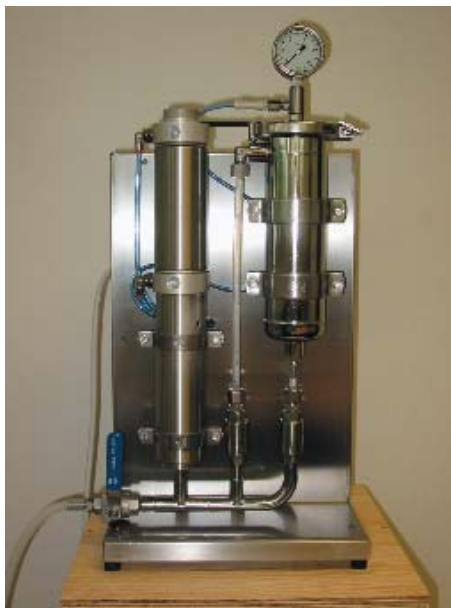
Fig. 2 - Vista del retro del modello da laboratorio del Naviglio Estrattore di capacità 1 litro.
