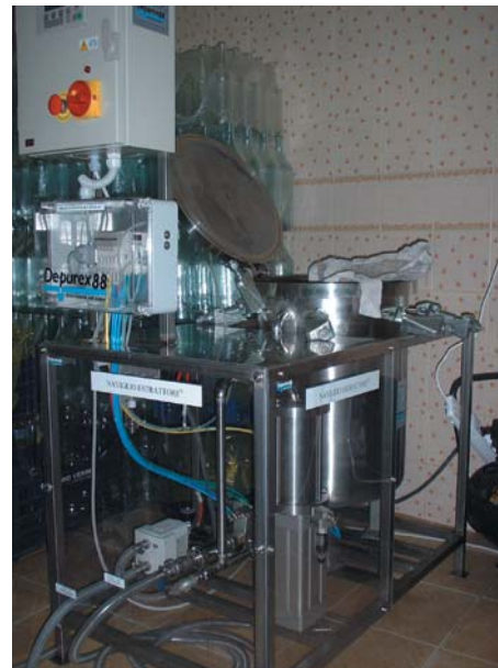
Fig. 3 - Vista laterale del modello industriale del Naviglio Estrattore di capacità 50 litri.
