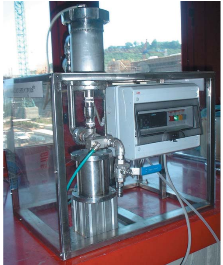
Fig. 2 - Prospettiva angolare del Naviglio Estrattore modello da un litro. Sono evidenti la camera di estrazione ed il quadro di controllo (PLC).
