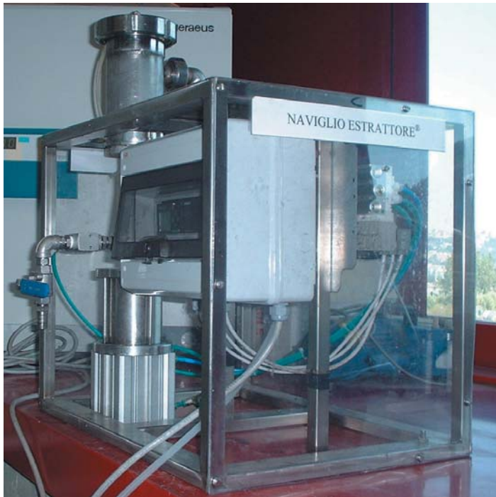
Fig. 1 - Prospettiva angolare del Naviglio Estrattore modello da un litro. Sono evidenti la camera di estrazione ed il quadro di controllo (PLC).
